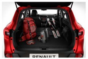
La modularité intérieure est facile et intuitive. Grâce à des poignées situées dans le coffre, le système « Easy Break » permet le déverrouillage et le rabattement automatique de la banquette arrière 1/3-2/3. En complément, le siège passager avant peut être positionné en tablette grâce à une poignée positionnée en contrebas du siège, afin de permettre le chargement d'objets de plus de 2,5 mètres de longueur.
