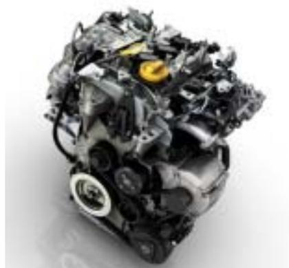
Le TCe 90 est un véritable surdoué au poids plume, puisqu'il pèse 15 kg de moins qu'un moteur de puissance équivalente. Il réussit à allier plaisir de conduite, maîtrise de la consommation de carburant (5 l / 100 km<sup>(2)</sup> pour Nouvelles Logan et Sandero) et réduction des émissions de CO<sub>2</sub> (116 g / km<sup>(2)</sup> au lancement pour Nouvelles Logan et Sandero).
