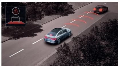
L'alerte de collision **avertit** le conducteur (alerte visuelle et sonore) de la **nécessité de freiner** pour éviter ou limiter un impact frontal. Le **freinage actif d'urgence** (*Active Emergency Braking System, AEBS*) peut **déclencher un freinage automatique** en cas d'urgence. Un radar avant détecte la distance avec le véhicule précédent (distance mesurée en secondes). Si le système détecte un risque de collision, des alertes visuelles et sonores sont d'abord déclenchées au
