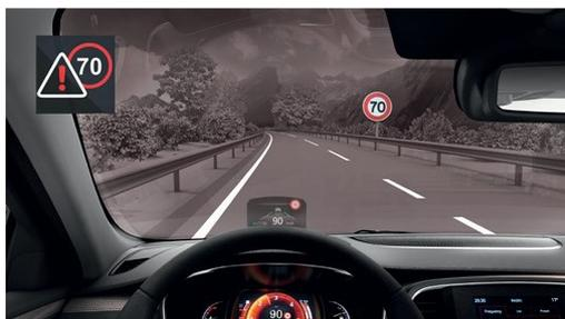
L'**alerte de survitesse** avec **reconnaissance des panneaux de signalisation** couplée avec la navigation (*Over Speed Prevention*) rappelle au conducteur la limitation en vigueur et l'avertit visuellement en cas d'**excès de vitesse**. La caméra fixée sur le pare-brise reconnaît les panneaux de signalisation et combine ces informations aux données de navigation pour déterminer la limite de vitesse.
