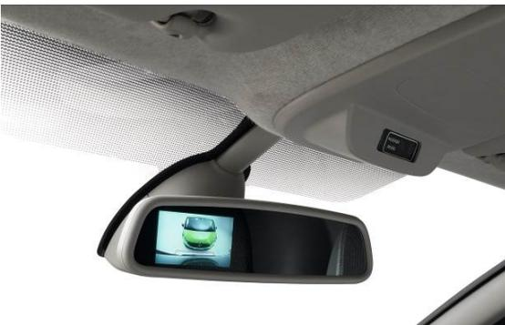
Disponible en 1<sup>ère</sup> monte, la caméra de recul est accolée au feu stop arrière en haut des portes arrière ou du hayon. Sa position en hauteur autorise une bonne visibilité de la zone arrière (visibilité à proximité immédiate du bouclier, perceptions des coins et du haut du véhicule) pour effectuer une manœuvre précise. Le retour image se fait dans le rétroviseur intérieur ou dans l'écran de la navigation pour les versions avec R-Link.
