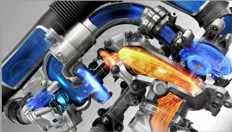
La technologie « Twin Turbo » permet de concilier **couple à bas régime** (80 % du couple max atteint dès 1 250 tr / min) et **puissance élevée** (allonge) sur un moteur Diesel, au bénéfice du plaisir de conduite.
