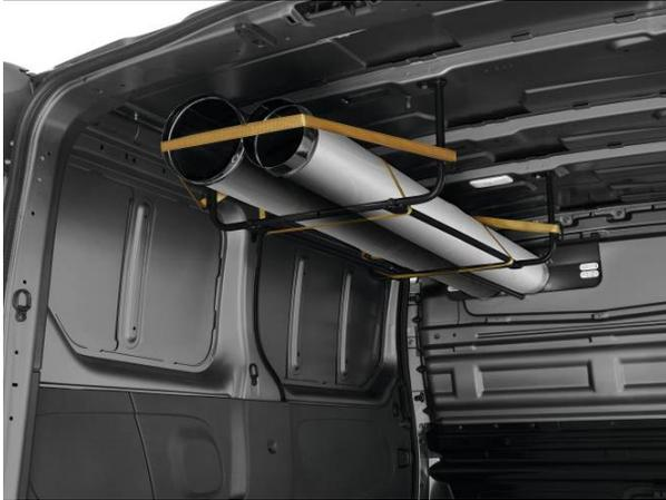
Pour gagner encore en volume utile, Nouveau Trafic propose (en option ou accessoire sur H1 seulement) une **galerie intérieure** d'une charge utile de 13 kg. La traverse de pavillon a été renforcée pour tenir le poids de la charge. D'une longueur de 163 cm, et d'une hauteur de 28 cm il est possible d'y ranger par exemple une dizaine de tuyaux de cuivre de 2 mètres ou un escabeau. Facilement démontable et transportable, elle peut être installée indifféremment à droite ou à gauche dans
