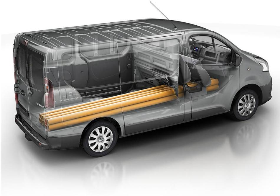
Nouveau Trafic est le seul fourgon de sa catégorie à pouvoir transporter avec les portes fermées des matériaux pouvant mesurer jusqu'à 3,75 m sur L1 et 4,15 m sur L2, et cela grâce à deux trappes. La première située au bas de la cloison permet de gagner 41 cm de longueur de chargement et la deuxième, sous le siège passager, augmente encore la longueur de 80 cm.
