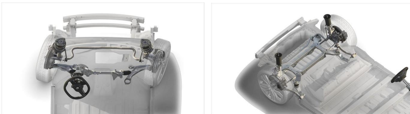
Enfin, la finesse de la batterie (110 mm) permet d'abaisser le centre de gravité du véhicule (-90 mm par rapport à une Megane thermique), au profit de l'agilité. La répartition des masses s'équilibre grâce à l'intégration de la batterie sous tout le plancher.
