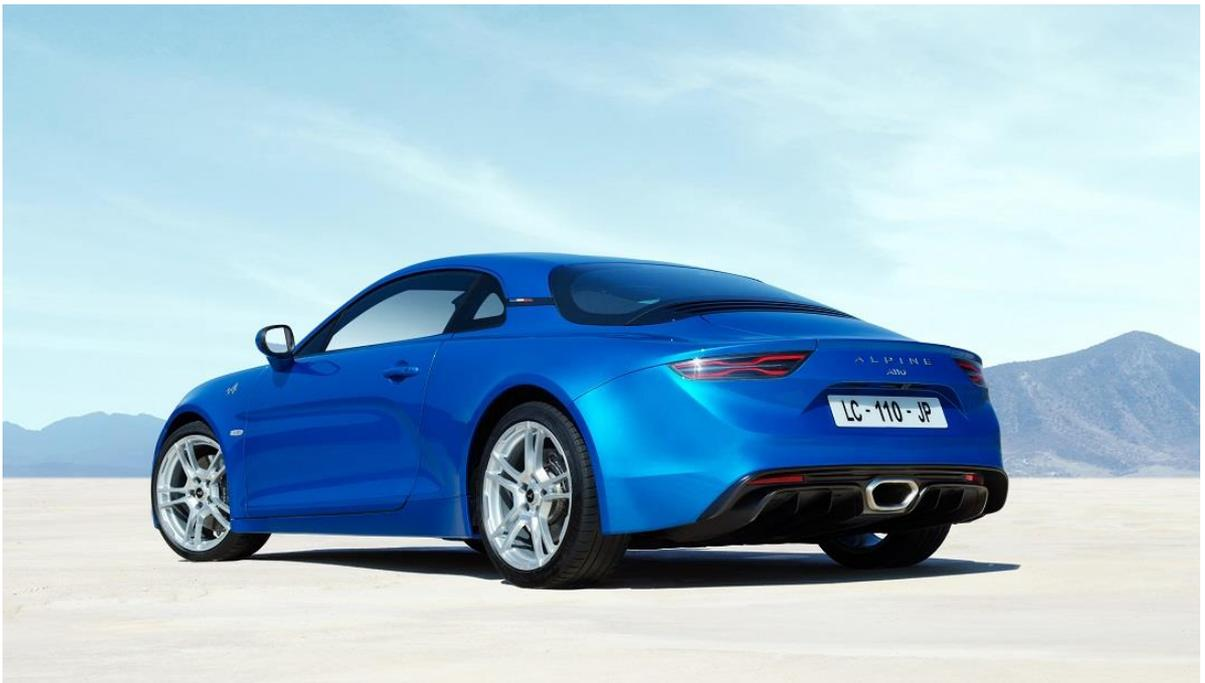
Désormais badgée « A110 », la A110 est la championne de l'agilité et du dynamisme grâce à une répartition optimale de sa masse (44% à l'avant et de 56% à l'arrière, moteur en position centrale arrière) et sa légèreté (1 102 kilos à vide). Equipée du châssis « Alpine » et de sièges Sport, l'A110 est source d'un plaisir de conduite pure, grâce à son efficacité et à son comportement communicatif en toutes circonstances.
